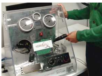
Grâce à un simulateur, les ingénieurs de Kereval testent la performance des logiciels embarqués, mais aussi leur compatibilité avec les standards et les risques d'intrusion dans les réseaux de communication.
